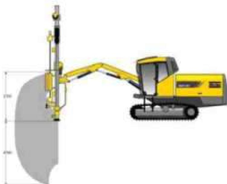
**Slika 6. Hidraulična bušilica Atlas Copco ROC D7**
