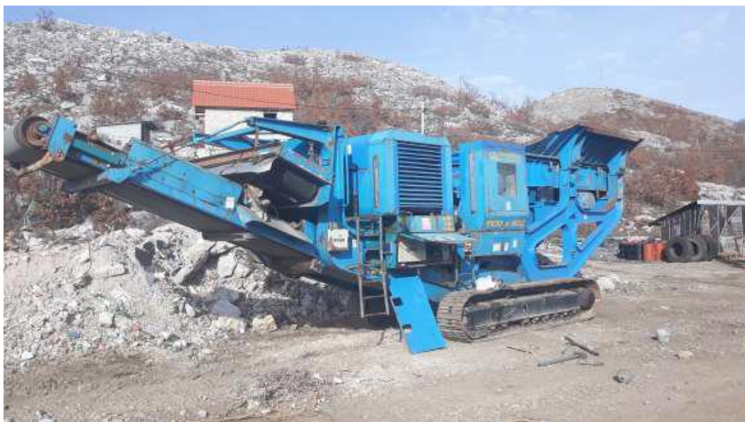
Slika 11 – Mobilno postrojenje za obradu građevinskog otpada
