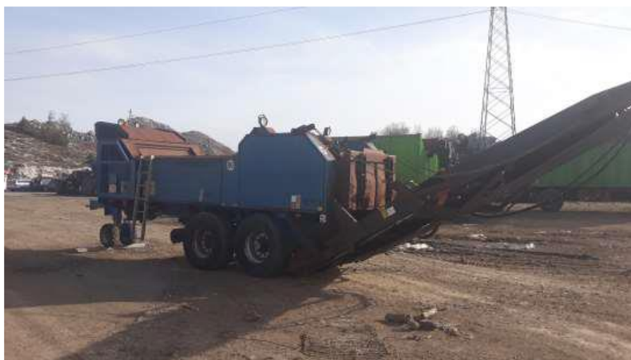
Slika 12 – Mobilno postrojenje za obradu biorazgradivog, kabastog i sl. Otpada
