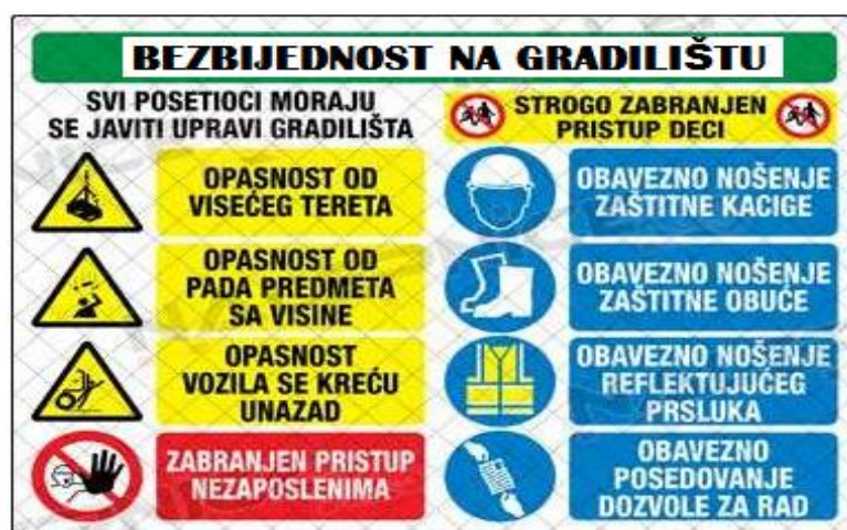
Slika 8. Znaci i upozorenja koji se moraju postaviti na ulazu u gradilište
